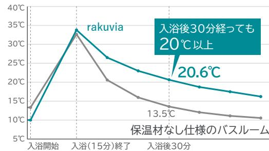
\* 外気温10°C、1坪用1616型(窓なし)の条件で試験を実施。浴槽に42°Cの湯をはり、入浴再現としてシャワー湯温42°Cを15分散湯。保温材なし仕様の壁、天井は厚さ9.5mmの不燃材仕様。(当社調べ/2015年10月・2023年6月)。ご使用の環境、条件により上記の測定値とは異なる場合があります。
